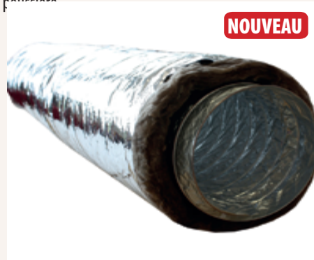
GSI GH ECOSOFT Conduits flexibles isolés en complexe alu/polyester constitué d'un conduit intérieur aluminium, protégé par un matelas de 25 mm de laine de verre ECOSOFT et recouvert d'un pare-vapeur polyester métallisé-polyester. Zéro phtalate, sans démangeaison, sans odeur, sans poussière
