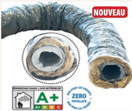
GP ISO ECOSOFT Conduits flexibles en PVC noir sans phtalate Laine de verre classée A+, protégés par un matelas de 25 mm ou 50 mm de laine de verre recyclable : liants naturels, sans démangeaison, sans odeur, sans poussière
